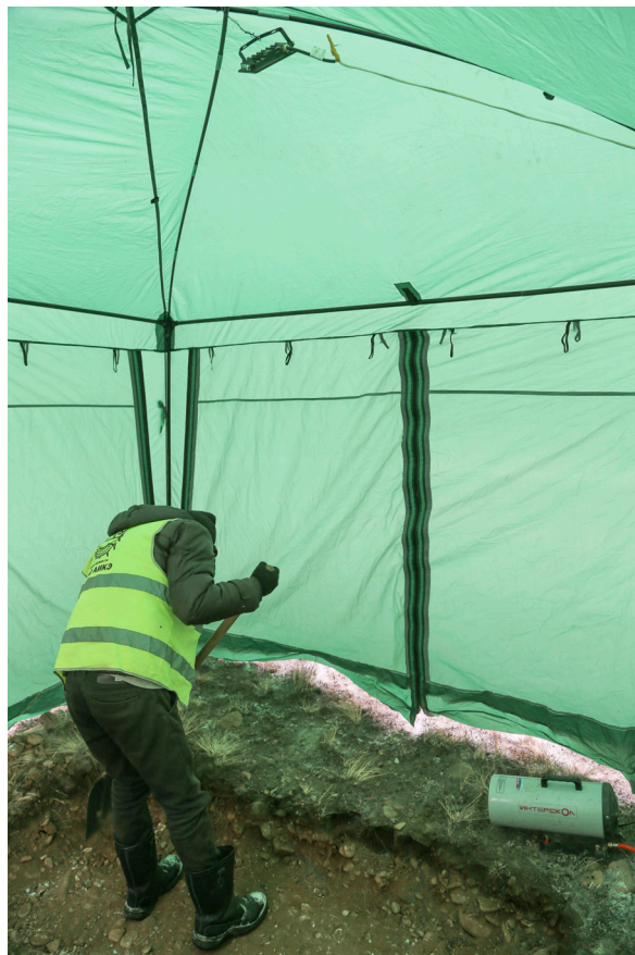
Рис. 20. Автовокзал в г. Кызыл. Рабочие моменты. Проведение шурфовочных работ в отапливаемом павильоне. Шурф №2.
