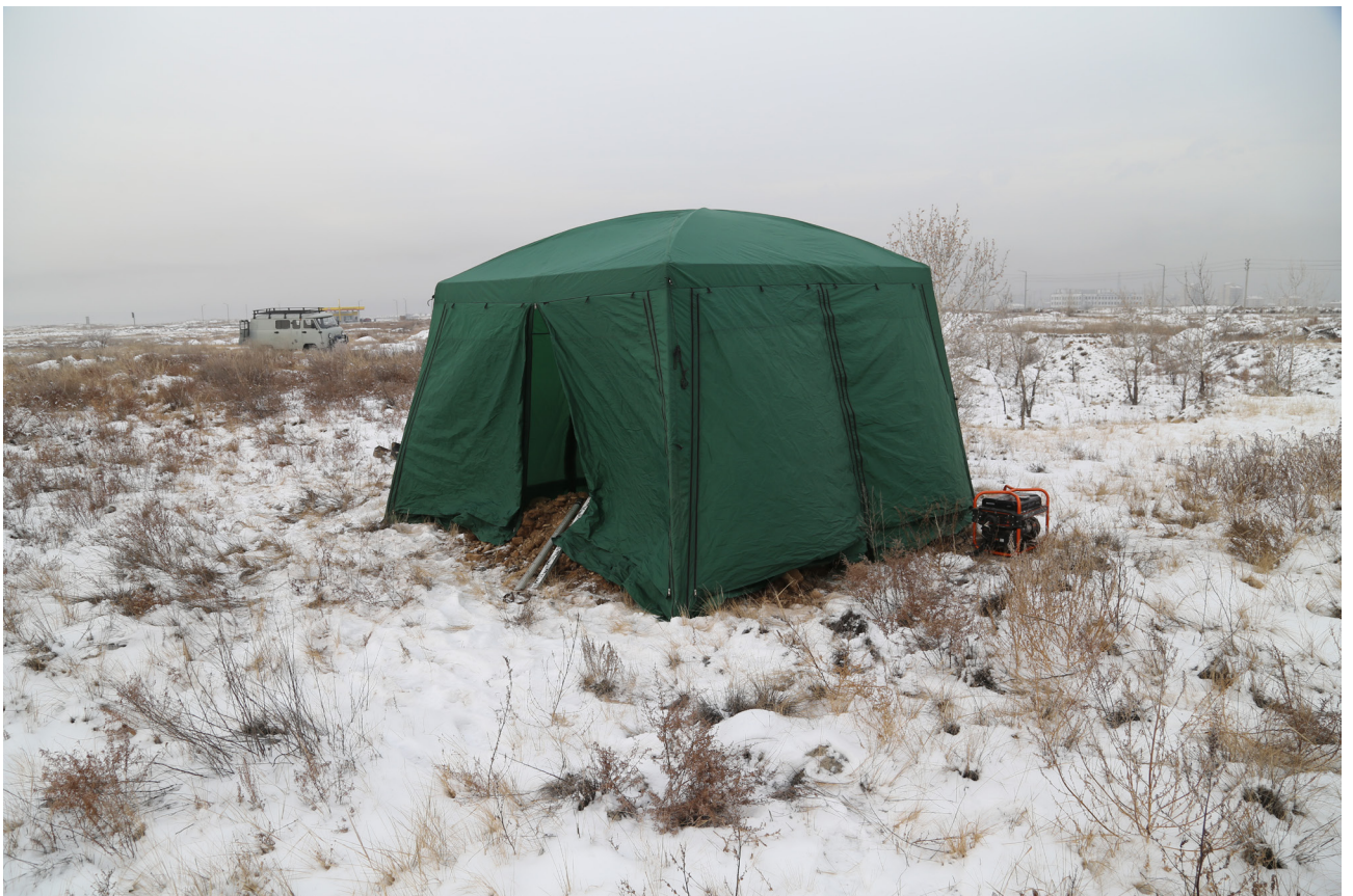
Рис. 16. Автовокзал в г. Кызыл. Рабочие моменты. Проведение шурфовочных работ в павильоне в условиях низких температур. Шурф №1.
